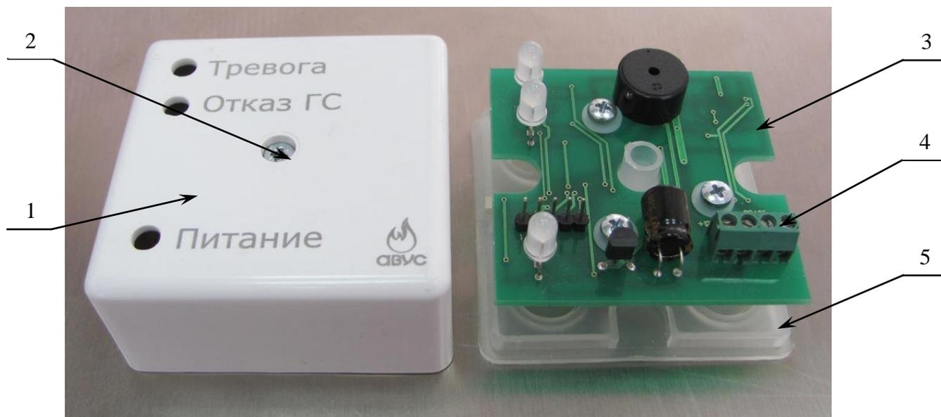
1 – крышка, 2 – винт, 3 – печатная плата с элементами, 4 – 4х-контактный винтовой клеммник, 5 – основание.
