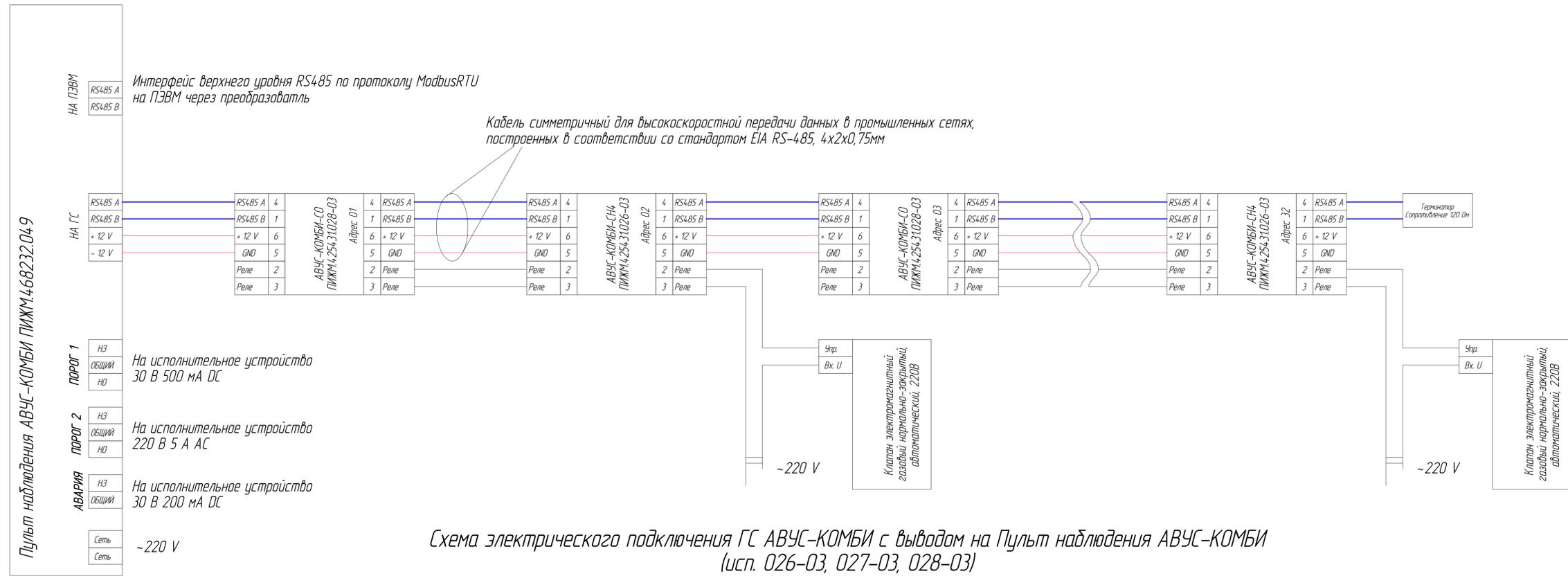
Схема электрического подключения ГС АВУС-КОМБИ с выводом на Пульт наблюдения АВУС-КОМБИ (исп. 026-03, 027-03, 028-03)
